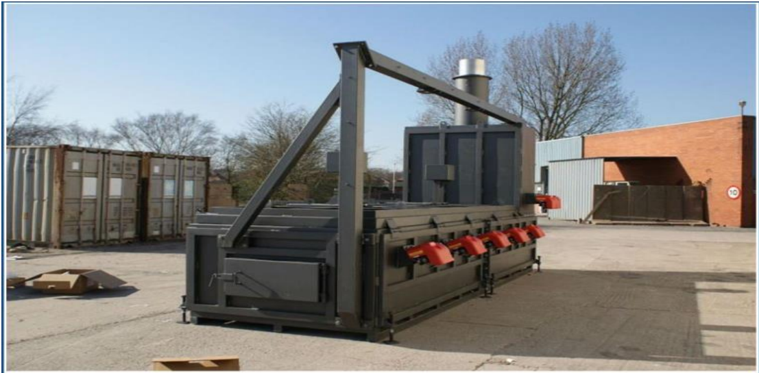
4- توضع المحرقة (المرمدة) على أرض صلبة حتى لا تحترق الحشائش والنباتات المجاورة.
