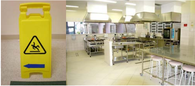
تصميم الأرضيات غير زلق يسمح بسهولة التنظيف والصرف
