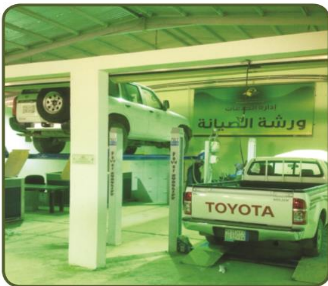
تجهيز ورشة مصغرة لفحص السيارات في مبنى ادارة الخدمات تحتوي على رافعتان محدثة بأحدث الوسائل وتقدم خدمة الفحص المبدئي عبر تقرير وإمكانية الفحص الشامل للسيارة.
